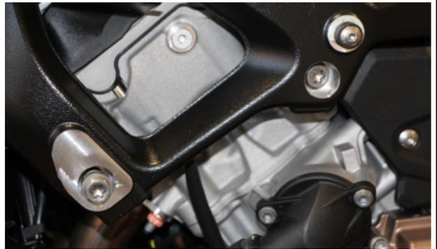
Die beiliegenden Distanzhülsen in den Rahmen einlegen. Mit den beiliegenden Unterlegscheiben und Schrauben das Sturzpad am Rahmen befestigen.
