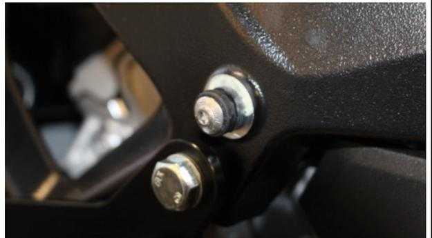
Die Distanzrolle mit der beiliegenden Schraube am Rahmen befestigen.
