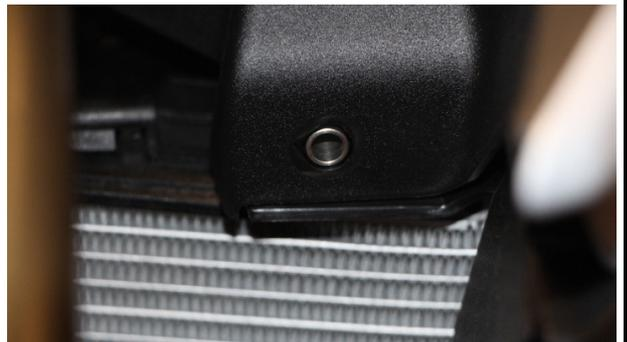
Verkleidung links und rechts lösen, aus den Halte-Zapfen ziehen und entfernen.
