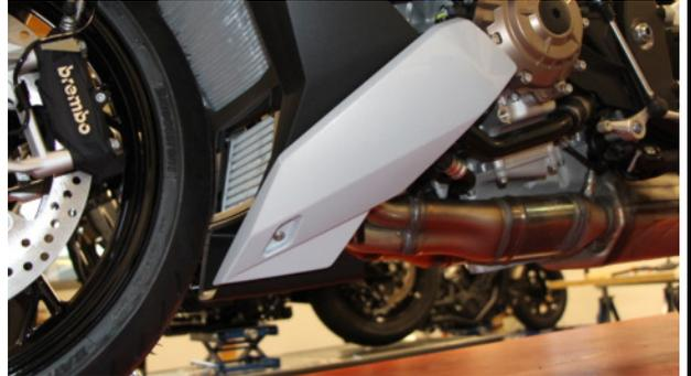
Die Innenverkleidung links und rechts lösen und komplett entfernen.
