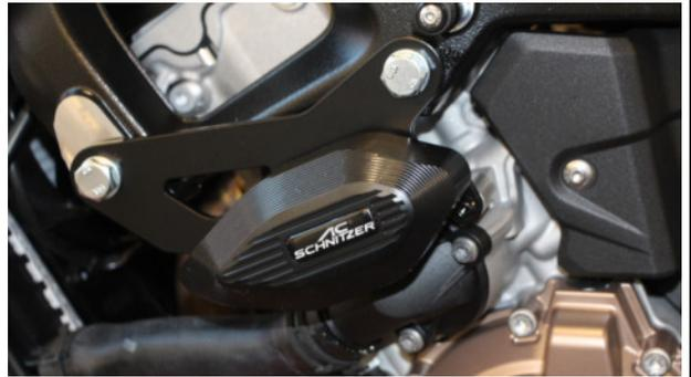
Die Halteschraube der Verkleidung auf der rechten Seite entfernen. Den Gummi von der Schraube abziehen und auf die beiliegende Distanzrolle drücken.
