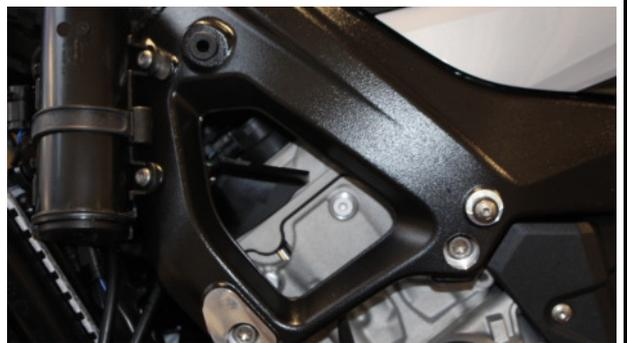
Beide Motorlagerschrauben auf der rechten Seite lösen und entfernen (diese werden nicht wieder verwendet).
