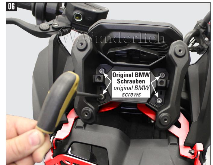
**Zum Schutz der Verkleidung, empfehlen wir Lackschutzfolie oder Moosgummi an den rot eingefärbten Stellen anzubringen.**
